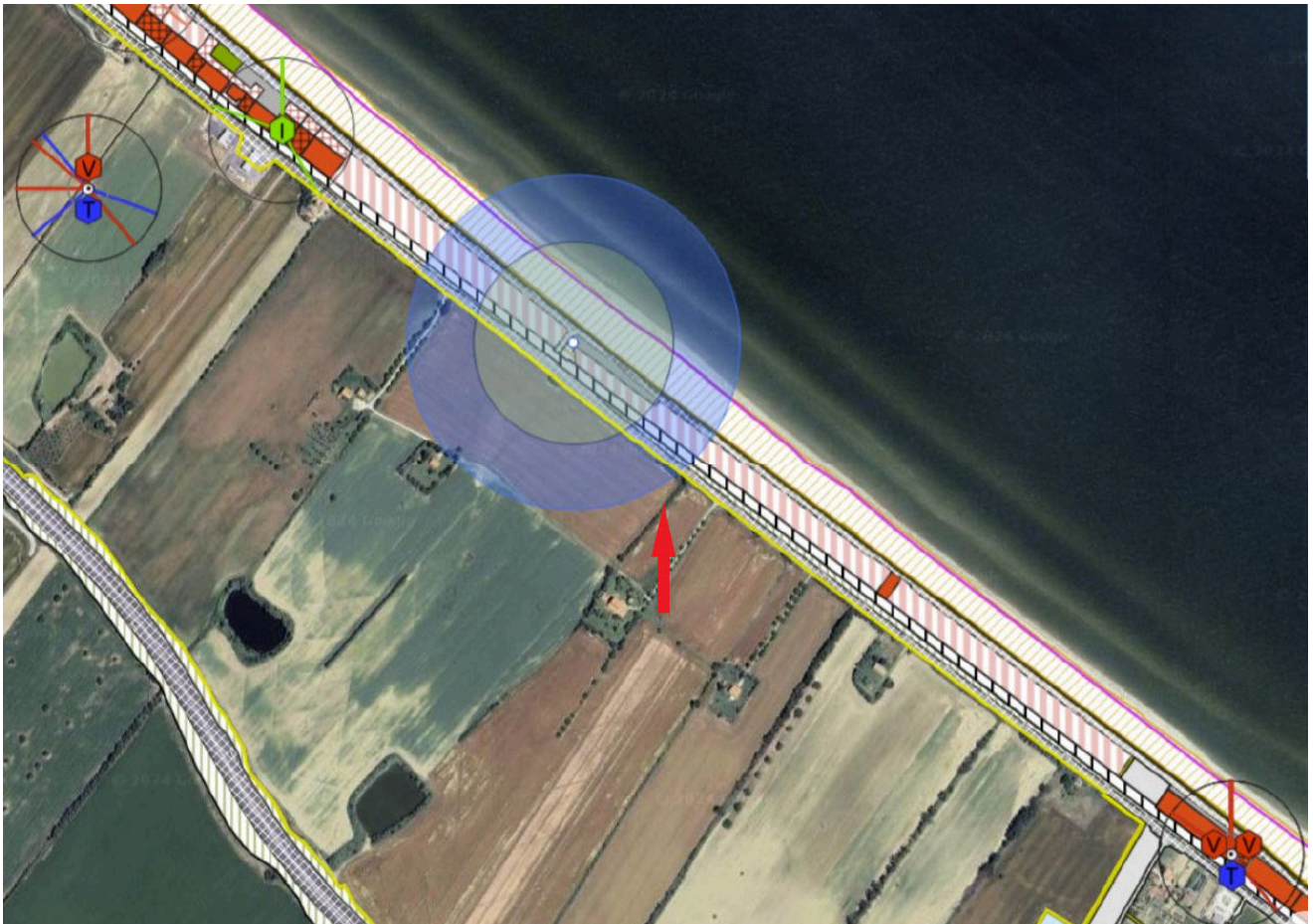
Fig. 37: area di ricerca ( cerchio azzurro) e area suggerita di installazione ( freccia rossa)
